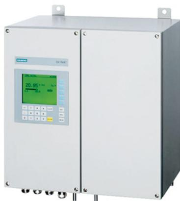
Газоанализатор Охумат 6 представляет собой высокоточный микропроцессорный прибор с парамагнитным детектором и предназначен для определения содержания кислорода в технологических газовых потоках и дымовых газах.
