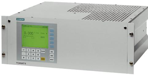
Газоанализатор FIDAMAT 6 используется для количественного измерения углеводорода. Прибор также подходит для измерений в корродирующих и конденсирующих газовых смесях. Принцип измерения основывается на методе обнаружения пламенной ионизации (FID) с пределом обнаружения около 0,1 ppm. При сжигании углеводородов в пламени водорода образуются ионы, которые под действием электрического поля в свою очередь преобразуются в ток. Полученная сила тока является мерой количества атомов углерода.
