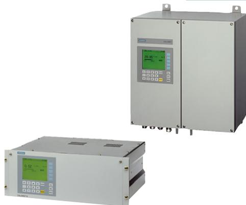
Газоанализатор Calomat 6 представляет собой прецизионный малоинерционный прибор с детектором теплопроводности и предназначен для анализа технологических двухкомпонентных (водород в азоте) или квазидвухкомпонентных (диоксид углерода в воздухе) газовых потоков.
